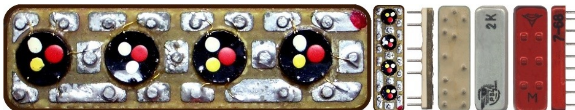
Рис. 9. Модули «Квант», вскрытые и в сборе
